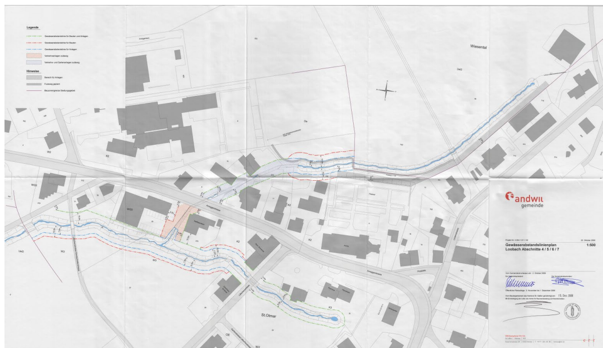
Abb. 4: Gewässerabstandslinienplan Loobach Abschnitte 4 / 5 / 6 / 7
