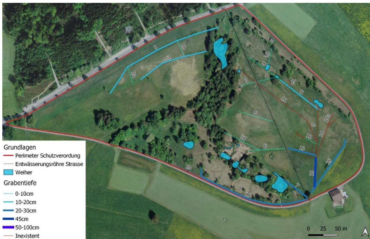
Abb. 7 Schematische Darstellung der durchschnittlichen Grabentiefen gemäss Felderhebungen. Die Gräben bis 10 cm Tiefe sind eingewachsen mit wenig Entwässerungswirkung. Allerdings beschleunigen selbst diese Gräben den Oberflächenabfluss bei Niederschlägen, die je nach Situation dem Moor fehlen können.
